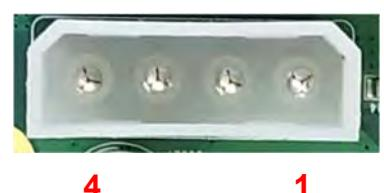
**DCIN\_4S1/ DCIN\_4S2/ DCIN\_4S3/ DCIN\_4S4: for Graphic card 8+8 power pin**
